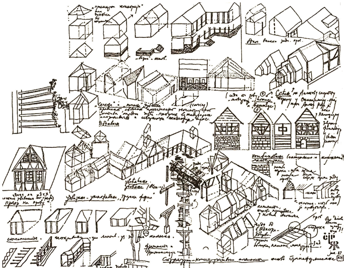
Сл. 1. Истраживања Ранка Радовића, 1987. године о конструктивним елементима кућа и могућим лекцијама из традиције / Fig. 1. Research on traditional housing construction elements by Ranko Radović in 1987
