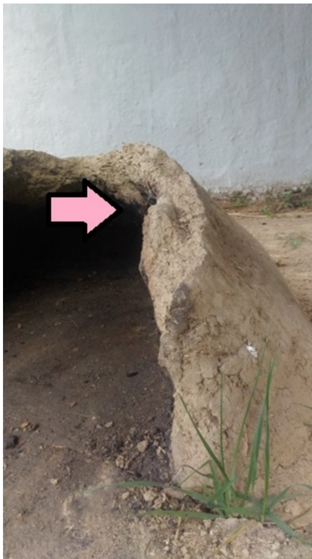
Slika 182. Ispupčenje pločice i sloj ojačanja preko nje – eksperimentalna peć (foto A. Đuričić)
